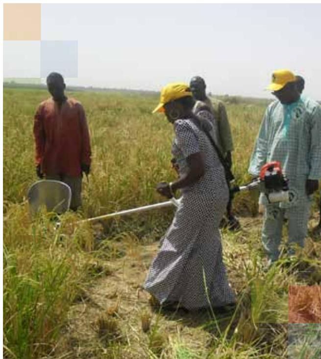
Essai d'une débroussailleuse dans une exploitation rizicole de l'État de Jigawa
